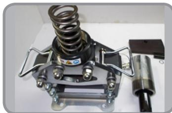
6. В момент извлечения штока из цилиндра в камере цилиндра будет создаваться вакуум, поэтому рекомендуем Вам для облегчения задачи вставить в БРС ответную часть без шланга РВД, тем самым открыв клапан БРС и обеспечив приток воздуха в цилиндр.
