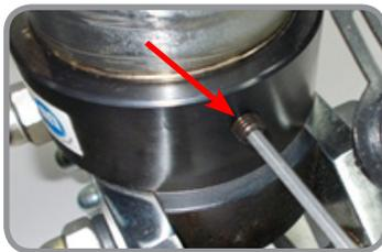
5. Выкрутите цилиндр вместе со штоком из корпуса, вращая его против часовой стрелки.
