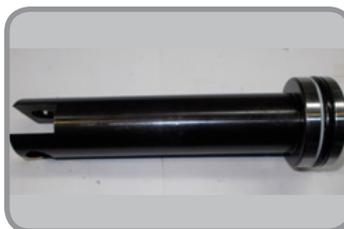
Будьте внимательны при установке колец, они должны быть установлены именно в той последовательности, как показано на фото. В противном случае, после первой же пробивки, кольца придется снова менять местами.
