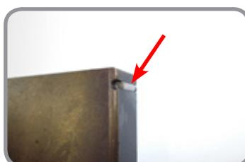
4. Выкрутите стопорный винт цилиндра
