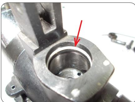
7. Установите плунжер, слегка смазав его маслом. Паз на плунжер должен быть развернут в сторону крепления подвижной рукоятки, как показано на фото.
