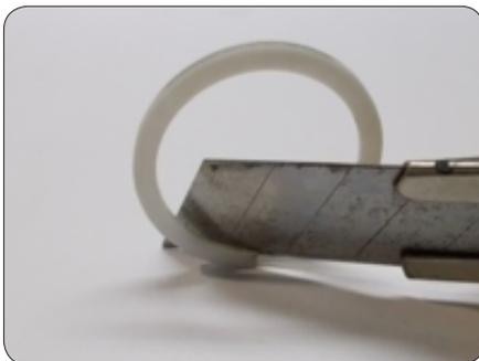
При помощи ранее изготовленных приспособлений, установите резиновое кольцо меньшего диаметра в нижний паз, а за ним в тот же паз установите фторопластовое кольцо того же диаметра. Резиновое кольцо должно быть ниже фторопластового.
