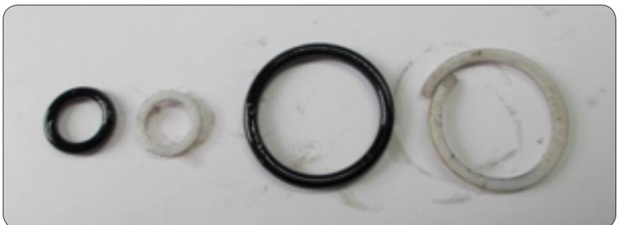
6. Возьмите два фторопластовых кольца соответствующего диаметра, установите их на ребро и сделайте разрез канцелярским ножом. Чем меньше будет угол между плоскостью кольца и плоскостью ножа, тем лучше.
