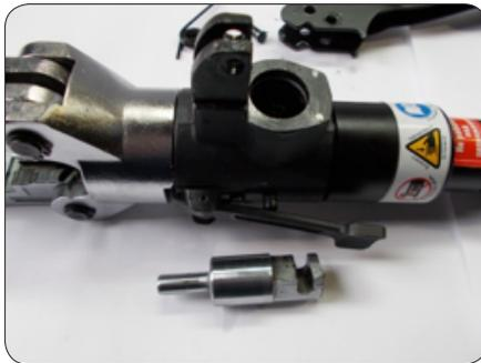
Внимательно осмотрите поверхность плунжера и внутреннюю поверхность цилиндра плунжера, на наличие задиров, рисок и глубоких царапин. Если таковые имеются, потребуется замена самого плунжера или же корпуса. Замена колец в этом случае вряд ли поможет исправить ситуацию.
