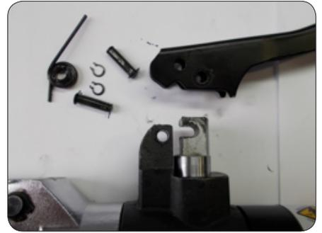
4. Извлеките плунжер, потянув его вверх (внутри плунжер ничем не закреплен).
