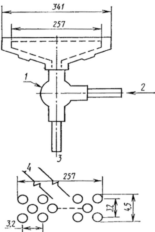
1 - смеситель типа Вентури для воздуха и газа; 2 - вход газа; 3 - вход сжатого воздуха; 4 - элементы горелки
