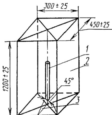
1 - образец кабеля; 2 - испытательная камера; 3 - ось горелки
