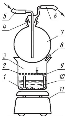
1 — противотурбулентные камни; 2 — опора для изделий; 3 — место для размещения изделий (высота около 75 мм, диаметр около 125 мм); 4 — зажимное приспособление для поддержки колбы; 5 — пуск охлаждающей воды; 6 — выход охлаждающей воды; 7 — двухлитровая колба из боросиликатного стекла; 8 — неплотно закрытый носик химического стакана; 9 — двухлитровый химический стакан из боросиликатного стекла; 10 — деионизованной воды 800 см<sup>3</sup>; 11 — нагревательная плитка
