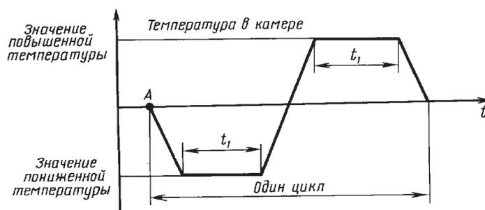
А — начало цикла;  $t_1$  — время выдержки
