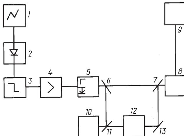
1 — осциллограф; 2 — частотный детектор; 3 — ограничитель; 4 — полосовой усилитель на частоту 30 МГц; 5 — фотоэлектронный умножитель; 6, 7, 11 — зеркала с коэффициентом отражения не менее 50 %; 8 — фокусирующая система; 9 — испытуемое изделие; 10 — газовый оптический квантовый генератор; 12 — устройство для сдвига частоты; 13 — зеркало с коэффициентом отражения не менее 90 %
