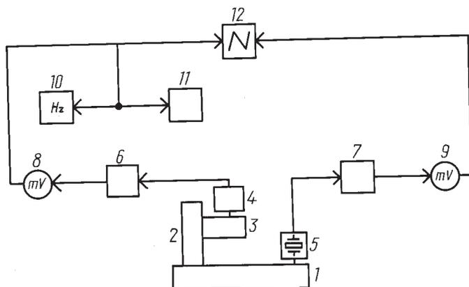
1 — стол вибростенда; 2 — приспособление для испытаний; 3 — испытуемое изделие; 4 — электретный вибропреобразователь; 5 — пьезоэлектрический вибропреобразователь; 6, 7 — катодные повторители; 8, 9 — милливольтметры; 10 — частотомер; 11 — самописец; 12 — осциллограф
