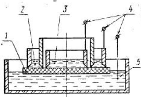
1—образец; 2—охраный электрод (ртуть); 3—измерительный электрод (ртуть); 4—контакты; 5—высоковольтный электрод (ртуть)
