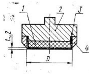
1—резиновый диск; 2—металлический держатель электрода; 3—диск из фольги; 4—металлическое кольцо; D—диаметр электрода
