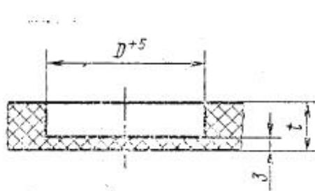
Трубчатый или цилиндрический образец
