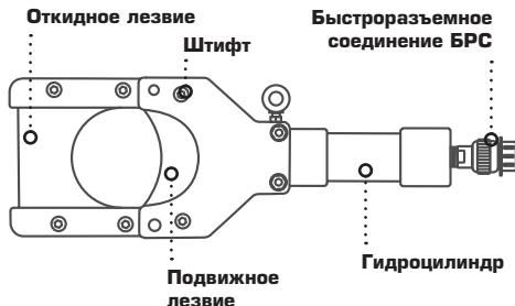
лением масла перемещает подвижное лезвие. При сбросе давления пружина возвращает поршень в исходное положение.
