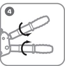
**Расфиксируйте рукоятки, повернув их вокруг оси**
