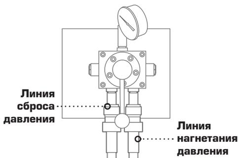
5. Подсоедините при помощи быстроразъемных соединений рукава высокого давления соответственно к линиям подачи давления и сброса нагрузки;
