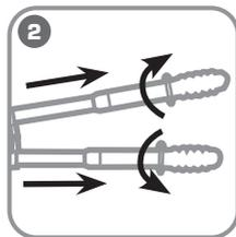
**2** Установите необходимую длину и зафиксируйте рукоятки, повернув их в противоположную сторону.
