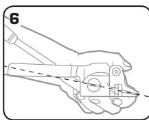
Возмите инструмент в левую руку. Установите прорезь оси по линии прорези в корпусе.
