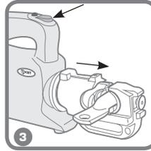
Установите опрессовываемое изделие между матрицами, нажмите на кнопку «ПУСК», произведите опрессовку. Держите нажатой кнопку «ПУСК» до срабатывания механизма автоматического сброса давления. При этом раздается характерный щелчок. При необходимости прервать операцию, отпустите кнопку «ПУСК».
