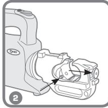
Установите матрицы в направляющие. Для установки верхней матрицы потяните фиксатор на себя, после чего установите матрицу. Для установки нижней матрицы нажмите кнопку «ПУСК» и выдвиньте шток так, чтобы кнопка фиксатора оказалась из рабочей головы. Установите матрицу.
