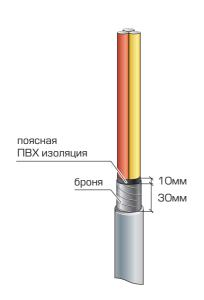
**2.1** Снять с кабеля оболочку и бронеленты согласно размерам, указанным на рисунке.
