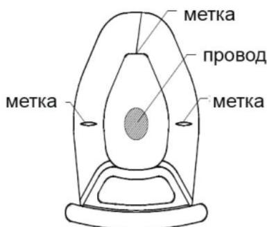
При измерении переменного тока расположите проводник строго по центру трансформаторных клещей, иначе может возникнуть дополнительная погрешность позиционирования около 1,5%.
