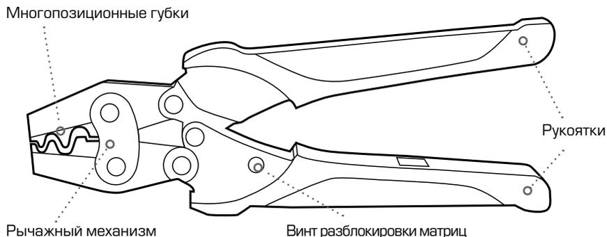
Усилие, прикладываемое, к рукояткам на сжатие через рычажный механизм, передается на многопозиционные губки. Скрытый храповой механизм гарантирует полный цикл опрессовки и обеспечивает блокировку обратного хода.
