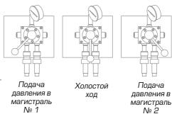
При переключении в режим сброса нагрузки рабочая жидкость сбрасывается из линии нагнетания и подается в полость обратного хода исполнительного механизма.
