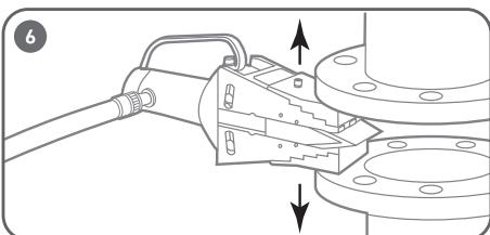
Произведите разгонку фланцев на необходимое расстояние. Установите предохранительный упор. Сбросьте давление в системе для возврата штока в первоначальное положение.
