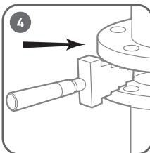
Установите между фланцами предохранительный упор. Сбросьте давление, извлеките инструмент из рабочей зоны.
