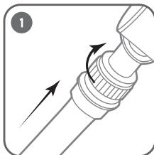
Подсоедините РВД к прессу через БРС. Плотно затяните гильзу БРС, приложив достаточно усилие (от руки) для обеспечения хорошего соединения (без применения слесарного инструмента).
