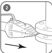
Установите инструмент между фланцами трубопровода.
