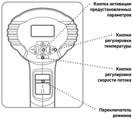
Фен TT-2000-3 LCD (КВТ) имеет два режима работы, которые устанавливаются посредством кнопки переключения, расположенной на рукоятке:
