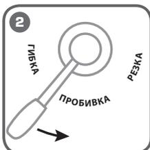
Поверните рычаг распределения потока рабочей жидкости в нужное положение в соответствии с выполняемой работой.
