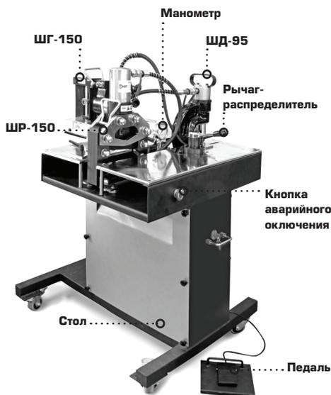
**!** Контролируйте рабочее давление в системе по встроенному манометру.
